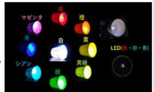
また、黄の補色である青色LEDと黄色で白を作り出すことが確認できる。黄色のLEDは純粋に黄色が放射されているが、実際には三つある錐体細胞の中の赤と緑の錐体細胞が反応して脳の中で黄色を感じさせているものと考えられる。
